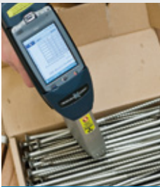
Appareil d'analyse de radiographie X-Ray X-ray analysis device
