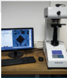
Duromètre premium Nexus Nexus premium hardness testing device
