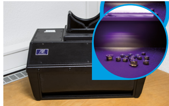
Dunkelkammer mit integrierten UV-Lichtquellen und Weißlicht
