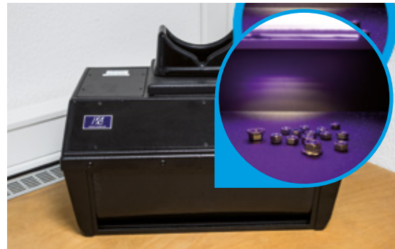
Dunkelkammer mit integrierten UV-Lichtquellen und Weißlicht
